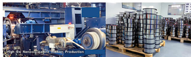
自動化された単口ロール液体急冷法による連続大量生産が確立されています
