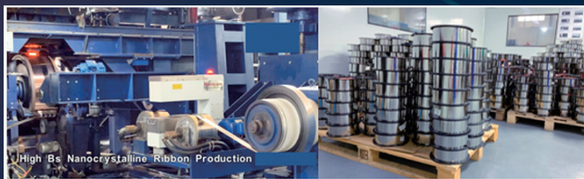
自動化された単ロール液体急冷法による連続大量生産が確立されています
